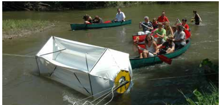
Abb. 4: „Luftgeformtes Wasserrad“ – Stromerzeugung im Fluss Feistritz, Pessl – Lehner, 2012 © Wachmann
